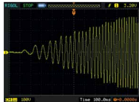
Beispiel Spannungs- und Frequenzanlauf
